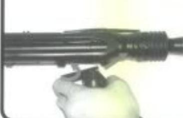
②必要に応じて下部のネジにて開脚角度を調整する
