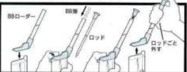
付属のBBローダーをマガジンにかぶせ、指でしっかりと押さえて固定します。パイプにBB弾を入れ、(最高25発まで入ります) ロッドで一気に押し込んでください。
