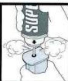
わずかでもマガジンにガスが残っている場合は、そのままマガジン底部のチャージ・バルブにWAニュー・スーパー・ガスのノズルを差し込み、ボンベを押し付けてください。適量は7g(約5~7秒)です。
