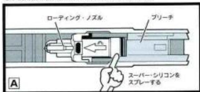
図「分解」の項目①～③を参照してフレームからスライドをはずし、ローティング・ノズルを前方へ引き出します。ブリーチの内部へWAスーパー・シリコンを約1秒スプレーしてください。
