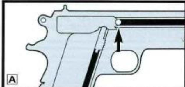
銃身後部のラバー・チャンバー（図A矢印部分）は消耗品です。発射の際のBB弾の飛距離が短くなったらラバー・チャンバーの交換時期です。次の手順にしたがって交換してください。
