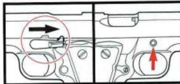
スライドを引き、スライド・ストップのツメをスライドの分解用の溝に合わせます。反対側よりスライド・ストップのピンを押し、抜き取ってください。
