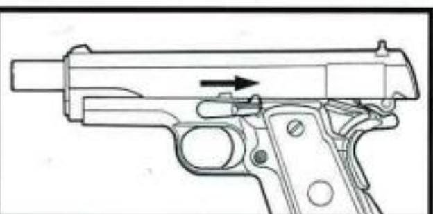
スライド・ストップは、まず軸の部分をスライド定位置の状態で途中まで差し込みます。続いて図の様にスライドを分解位置まで引いて、分解用のミゾに最後まで押し込んでください。
