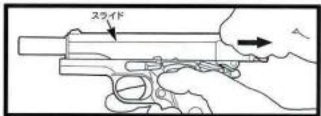
スライドを一杯に引き、手をはなしてください。初弾が一発装填され、同時にハンマーが起動されます。
