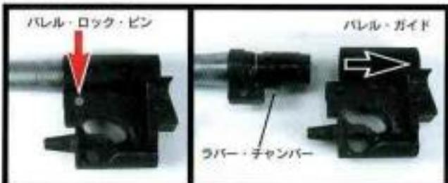
1.5mm径のポンチ等でバレル・ロック・ピン（赤矢印部分）を押し出して、バレル・ガイドを取りはずします。ラバー・チャンバーを交換してください。
