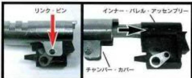
1.5mm径のポンチ等でリンク・ピン（赤矢印部分）を押し出して、チャンバー・カバーからインナー・バレル・アッセンブリーを抜き取ります。
