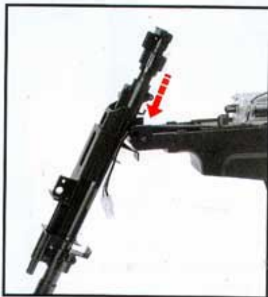
4. Install the barrel 安装枪管
