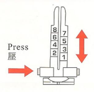
Elevation(up/down)adjustment button 仰角(上/下)調節按鈕
