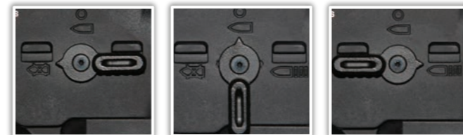
セーフティオン 発射できません セミオート 単発 フルオート 連発
