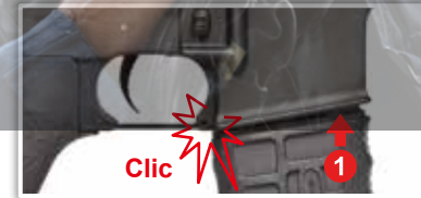
1. Insérer le chargeur dans le puit de chargement jusqu'à entendre un clic.
