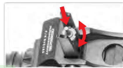
下壓星尖後可以旋轉調整低。 順時針：調高 逆時針：調低
