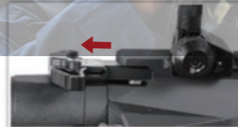
Tirer sur le levier de chargement va tirer la culasse en arrière et ouvrir le capot latéral.
