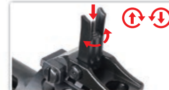
Appuyez sur le bouton pour régler la hauteur. Tournez dans le sens horaire pour élever le point d'impact. Tournez dans le sens antihoraire pour baisser le point d'impact.
