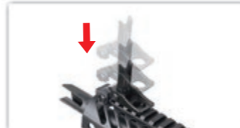
Installez le guidon sur le rail.
