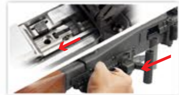
Tire hacia atrás de la manija de carga hasta el final hasta que la unidad de salto encaje en su lugar.
