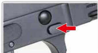
Appuyez sur le bouton de libération du loquet de démontage.
