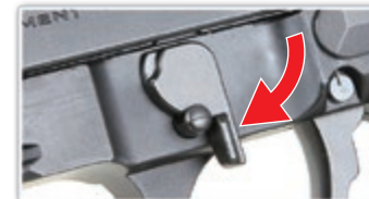
順時針旋轉分解桿至定位。
