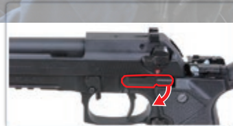
壓下滑套後定桿並向前推出滑套。
