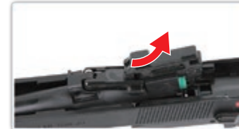
取出外管，分解後可進行適度清潔及噴塗矽油保養。
