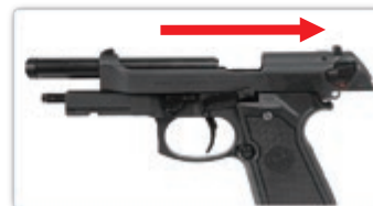
將滑套拉至後方使擊錘後定。
