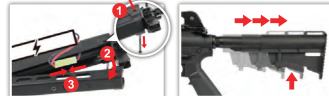
1. 移除上下護木固定PIN針。 2. 移除上護木。 3. 接上電池接頭。 4. 確認電線放妥後，方得蓋回護木，以免電線破損。 壓下調整片調整適合之槍托長度 (可5段調整)。
