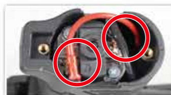
無作動 檢查馬達連接線(需卸下底板)。
