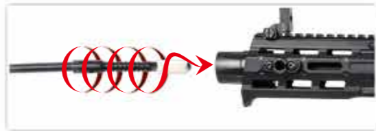
將通槍條插入內管・旋轉通槍條帶出髒汗・重複以上步驟直到內管清潔。
