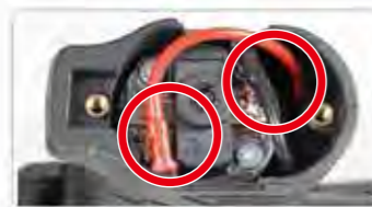
無作動 檢查馬達連接線(需卸下底板)。
