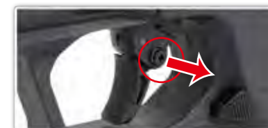
Empuje el selector del seguro hacia la izquierda.
