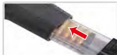
Insérez le chargeur.
