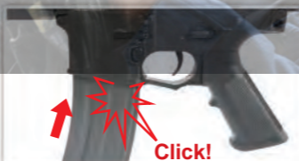
Inserte el cargador dentro del recibidor hasta que escuche un sonido "Click"
