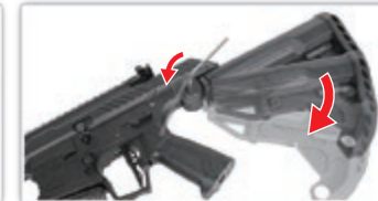
使用5毫米內六角扳手擰鬆六角螺絲以調整槍托的角度。
