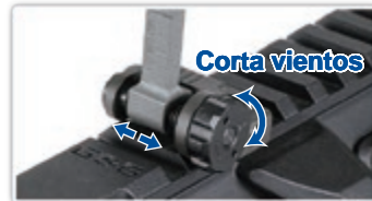
Perilla corta vientos (Ajuste Izq./Der.)
