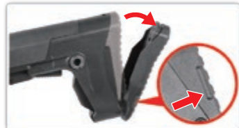
Presione el liberador de Cantонера (ambos lados).
