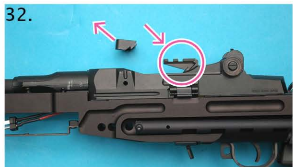
32) 更換鏡台座 Replace rear scope mount base
