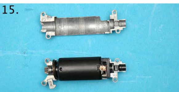
15) 安裝G&P附加馬達殼 Assemble G&P motor housing
