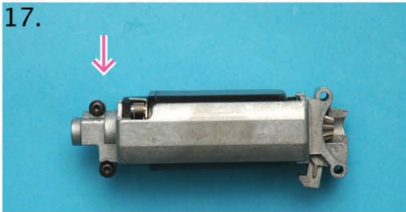
17) 安裝螺絲鎖緊馬達 Install and fasten the screws
