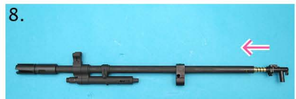
8) 安裝 Install inner barrel
