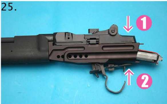
25) 把槍機及G&P護環安裝 Reinstall trigger guard
