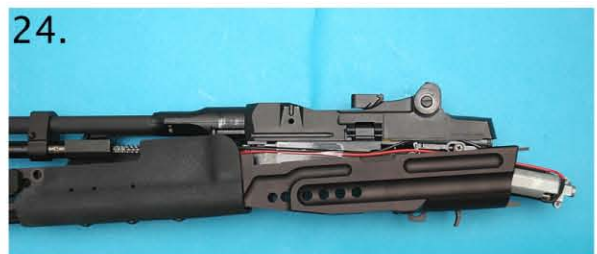
23) 安裝前先分解 Separate grip and lower handguard
