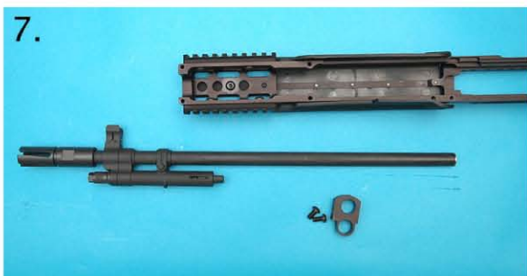
7) 分解 Remove outer barrel and barrel guide
