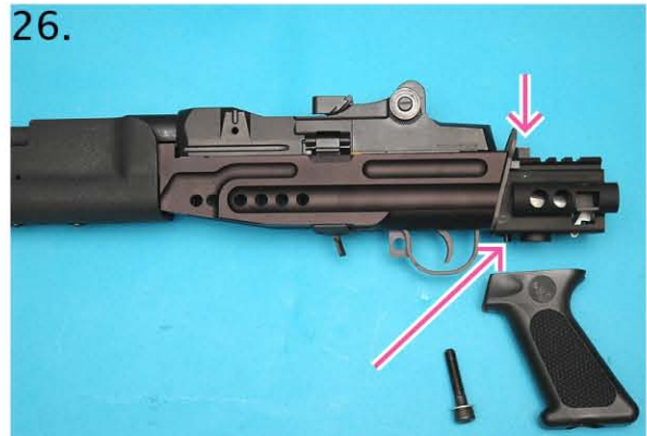
26) 安裝螺絲固定 Fasten screw
