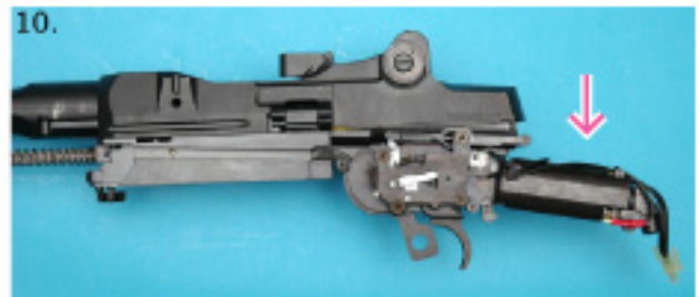
10) 拆除馬達電線 Remove the motor and power cords
