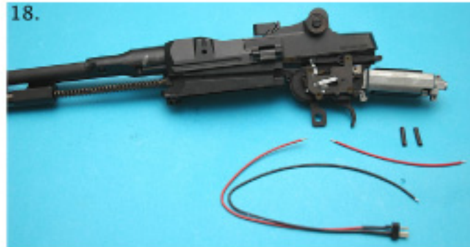
18) 安裝電線 Connect power and motor cords
