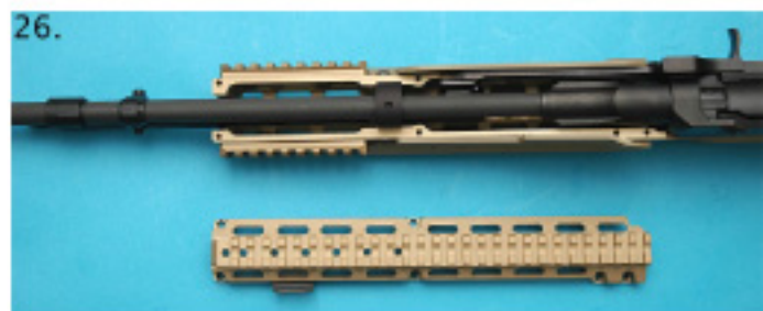
26) 安裝頂機 Install the upper receiver
