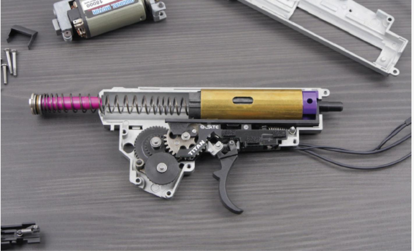
24. Instale el resto de los componentes externos de la caja de cambios y comience a colocar los cables. Puede utilizar la imagen de abajo o su cableado anterior como una sugerencia.
