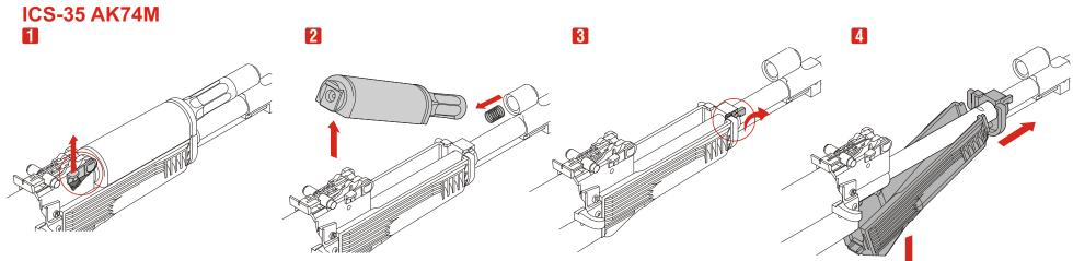
將上護木環固定鈕扳起。 Pull up the upper handguard fixed lever. 將上護木環整個往上拉,上護木及 彈簧可卸下。
