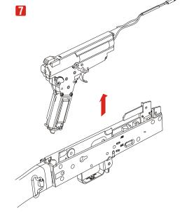
將 BOX 取出 Pull out the gear box.
