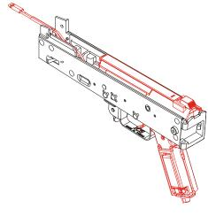
將線材拉到最佳之位置,避 冤壓到線,並確認電線已裝 入BOX中。
