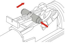
將覘孔調整鈕往前推, 卡住射擊所需的刻度。
