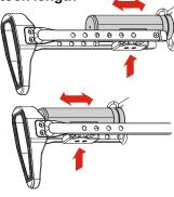
按下卡榫,即可將伸縮托向後拉或向前推, 共有 6 段可供調整長度。
