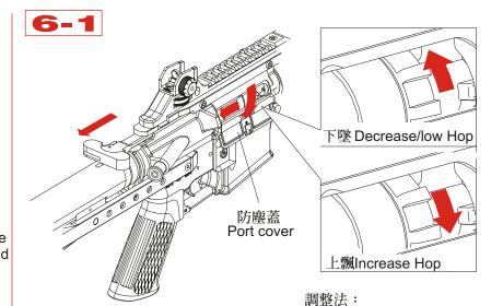
將槍機拉柄向後拉,防塵蓋即打開 Pull backward the charging handle opens the bolt covers for adjustment of Hop-up unit. 子彈如果向上飄,將 Hop - up 環向上旋轉,如果向下墜就要向 下旋轉,讓 B.B. 彈呈一直線的 射出才是正確的位置。 Adjustment
