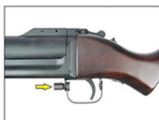
3. Le pontet peut se plier sur la gauche ou la droite après avoir appuyé sur le bouton.
