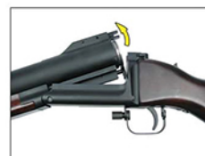
5. Enlevez la cartouche vide, appuyez sur le levier de verrouillage du canon. L'extracteur éjectera la cartouche.
