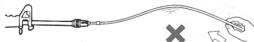
注意 後の方を持つと、入っていきません。 CAUTION Inserting the rod will be difficult if you hold rod at the end.
