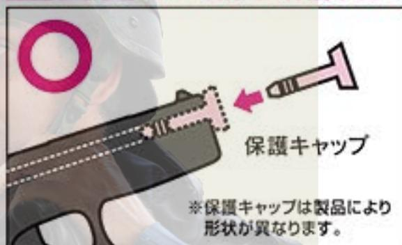
万一の暴発を防ぐと共に、防塵のためにも、発射する時以外は必ず銃口に保護キャップを装着してください。また、保護キャップを装着したままで、トリガーを引かないでください。
