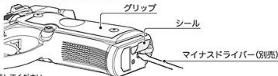
\*マガジンを抜いて弾が残っていない事を確認して、保護キャップを装着してください。
