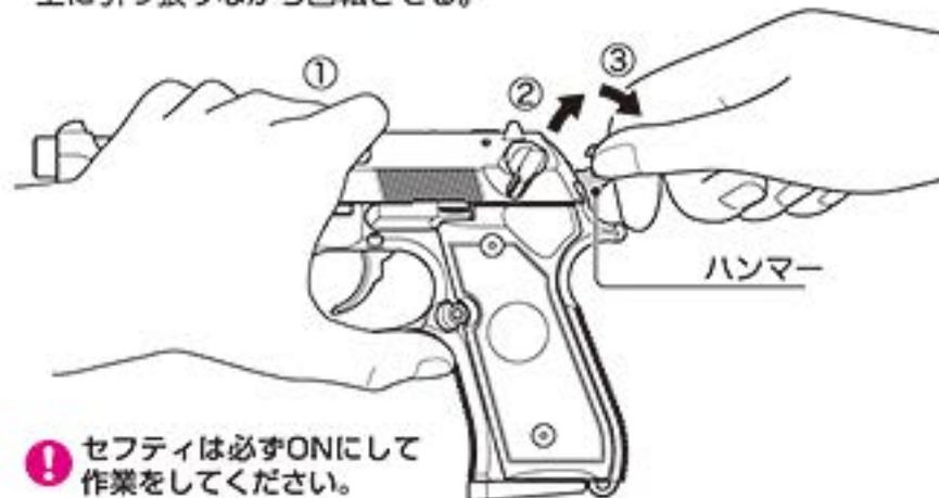
②スライドの後方を持ち上げてスライドを外し、銃口に保護キャップを装着する。
