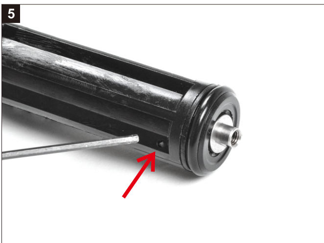
5 移除進彈浮動嘴尾座。 Remove the Piston
