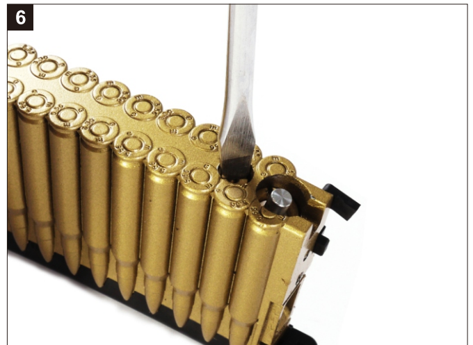
卸下灌氣嘴，完成。 Remove the Inject Valve.
