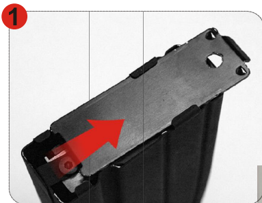
1 推開彈匣底板 Slide open the baseplate.
