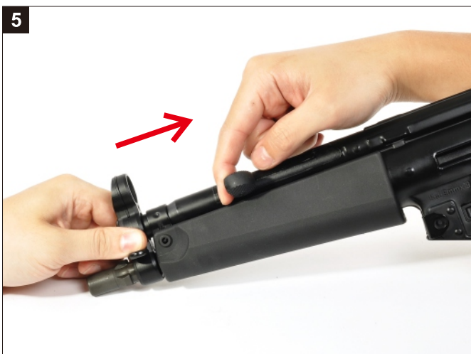
5 拉動槍機拉柄，使槍機組向後退出。 Pull the Cocking Lever rearward.
