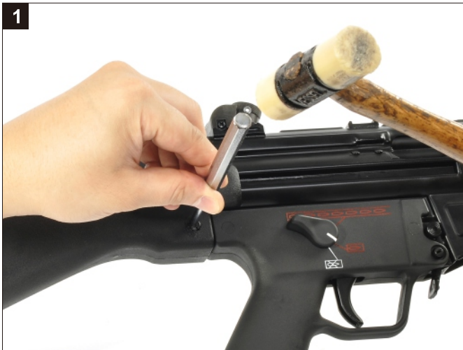
1 移除槍托插梢。 Remove the Rear Pin.
