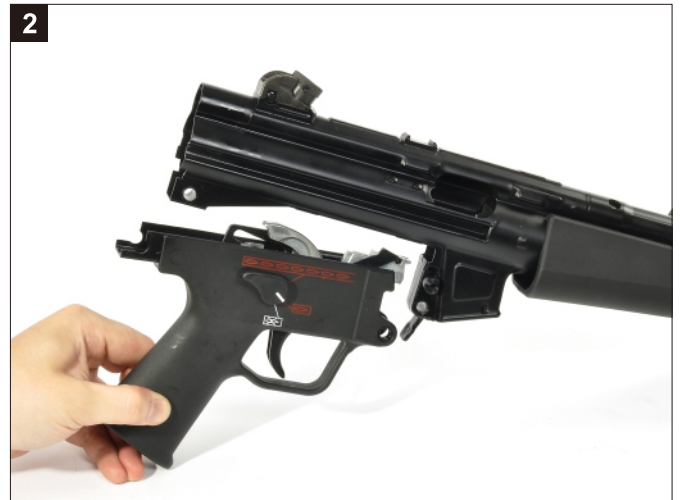
卸下扳機組。 Remove the Trigger Group.
