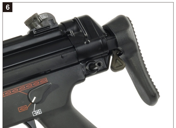
6 安裝槍托插梢，完成。 Replace the Locking Pin.
