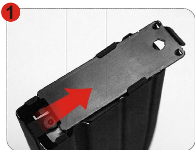
1 推開彈匣底板 Slide open the baseplate.
