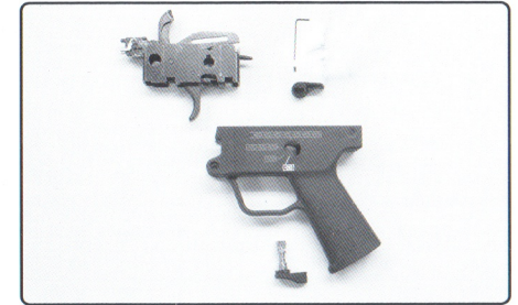
完成扳機組件取出
