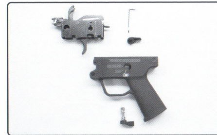
完成扳機組件取出
