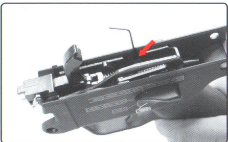
利用六角扳手工具取下螺絲,即可鬆脫扳機組
