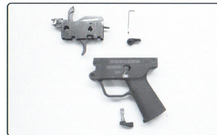
完成扳機組件取出
