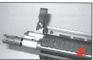
立起或摺疊位置定位正確時，準星卡筭都會自動彈起鎖定準星 The button will be auto-lock when the sight on the position.
