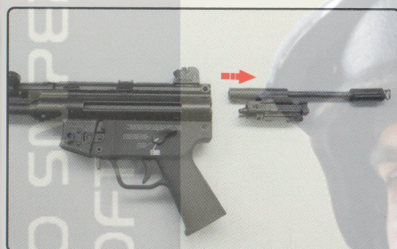
注意若要将槍機組組合回去,首先要先將下槍身分位(擊鈕下壓),否則若槍機先進入時連發桿會卡死
