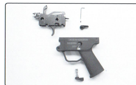
完成扳機組件取出
