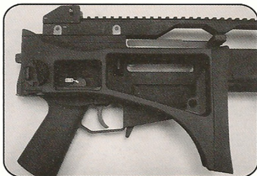
按壓槍托摺疊鈕, 即可將槍托摺疊至定位
