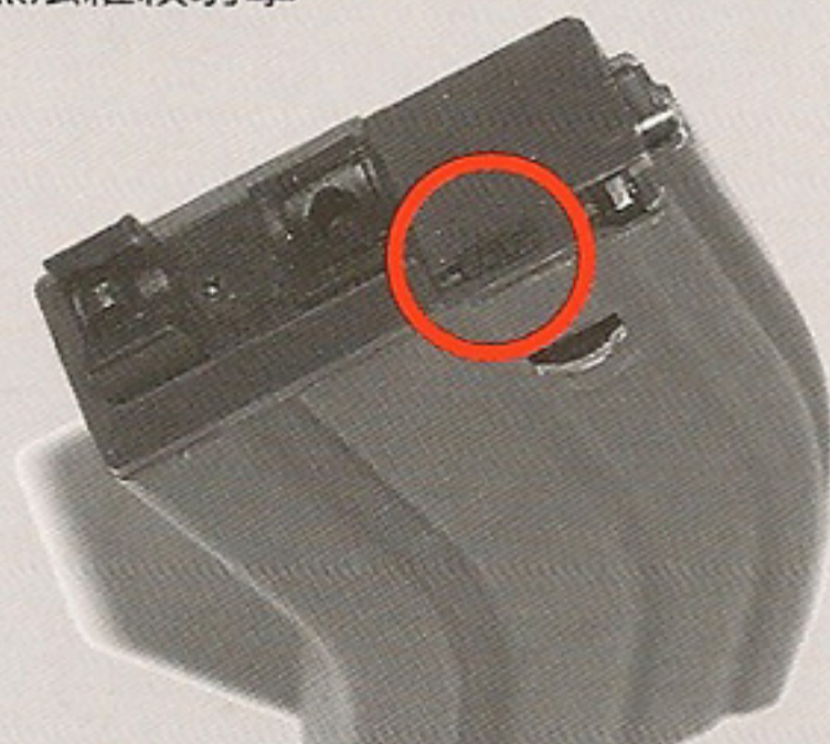
防掛機ON，子彈打完槍機不會固定，可繼續打空槍直到瓦斯用罄。
