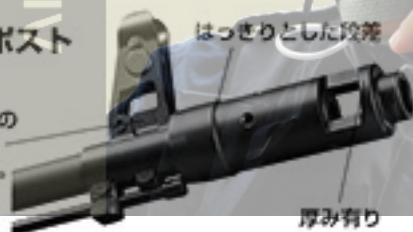
▲ AK74MNの1985年~1989年型 マズルブレイキとフロントサイトポスト
