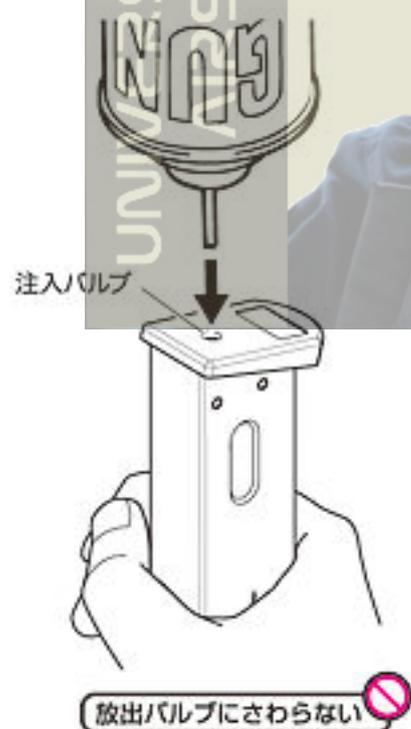
② マガジンとガスポンベを一直線にして垂直に持ち、ガスポンベをマガジンに押し付ける。
