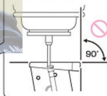
※注入を始めた途端にバルブからガスが噴き出す場合は、バルブとノズルがズレていたり、マガジンとガスポンベが一直線になっていません。
