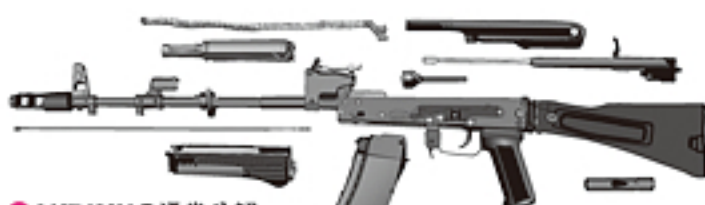
●AK74MNの通常分解 マズルブレイキが2穴式の試作だが、他はほぼ最終形態と思われる。ストック 側面の長方形の凹みは畳んだ時にマウントベースが干渉しない様に設けられている。
