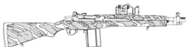
●「M14A」バリエーション2…16インチバレルの「SOCOMアーバン」
