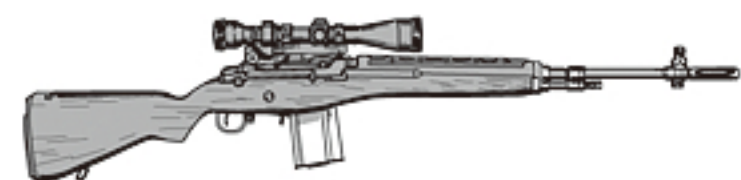
●M21スナイパーライフル セレクターレバーが除かれ、セミオート位置で固定されている。
