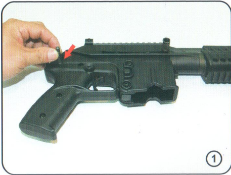
先將槍身後插梢取出 Remove Assembly Pin.
