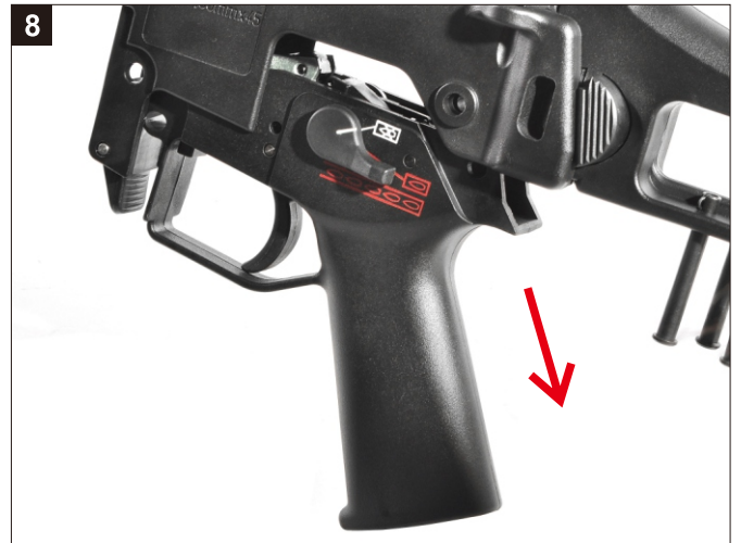
卸下扳機組。 Remove the Trigger Group.
