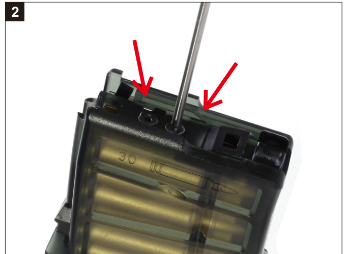
卸下彈匣固定螺絲。 Remove the Screws from the Magazine.
