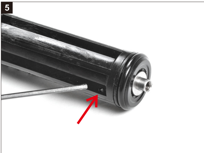
移除進彈浮動嘴尾座。 Remove the Piston
