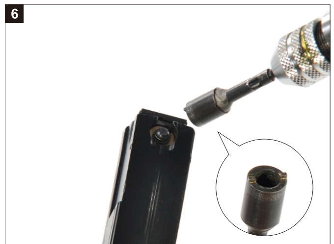
以專用工具將彈匣氣閥卸下，完成。 Remove the Valve by using a specific tool.
